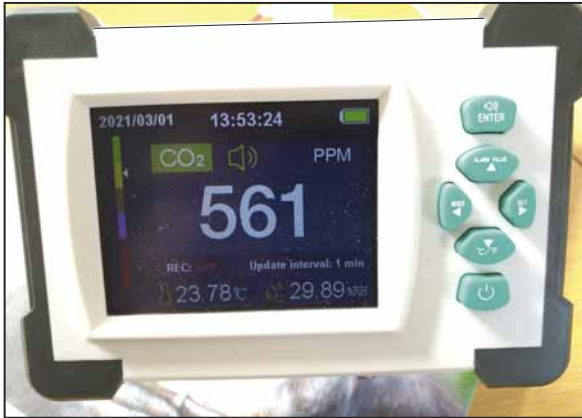
CO 2 -Messgerät zur Prüfung der Luftqualität
