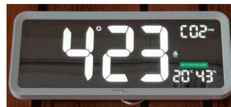
Die CO 2 -Messgeräte überprüfen permanent die Raumluft und zeigen die Werte im Display.
